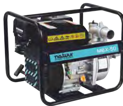
MBX 50 146054 Gasolina 6,5 Cv. Caudal máximo 36.000 ltr/h. Altura manométrica máxima 25 m. Auto-aspirante 7m. 2"-50mm.
