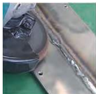
Limpieza en cordones de soldadura
