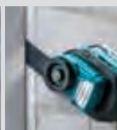
Corte de masilla de ventanas, silicona
