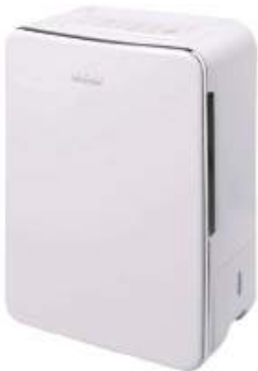
TOYOTOMI DESHUMIDIFICADOR 142779 8 L/día (20°C/60 HR) sin gas refrigerante, desecante. Muy silencioso. Funcionamiento de 1°C a 40°C. Eficiencia constante, incluso en condiciones de altas y bajas temperaturas. Sensor de humedad y humidistato ajustable. Modo colada. Autorestart. Filtro anti-bacterias de nanopartículas de plata. Posible drenaje continuo. Temporizador. Modo anti- condensación. Fácil manejo, ligero, con asa superior. Panel táctil. Tecnología Japonesa 259'00
