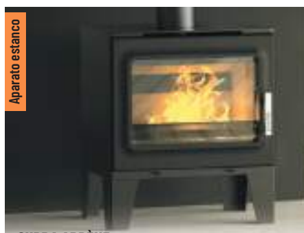
SUPRA ARDÈNE 23022577 6,1kW (3-10kW). 61,5 x 43,8 x 69,3 cm. Cuerpo de acero, puerta hierro fundido. Vermiculita de alta densidad. ø Salida 150 mm. ø Aire 100 mm. Compatible hogares eficientes. Salida humos superior o posterior. Turbina opcional. Rendimiento 77,7%. Consumo 1,5 Kg/h.
