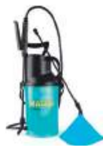
PULVERIZADOR PRESIÓN PREVIA BERRY PLUS 145805 Capacidad útil 5 L, manguera PVC 1,3 m. Incluye: alargadera de 0,42 m y campana cónica con boquilla de abanico. Lanza de fibra de vidrio. 44'95
