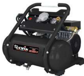
COMPRESOR SILENCIOSO PRO 6LT 1HP 23001720 Motor de 1hp (0,75kw) sin aceite capaz de aspirar hasta 156 litros/minuto y hasta 8 bares de presión. Su calderín capacidad de 6 litros y purgador. 95'03 + IVA = 114'99
