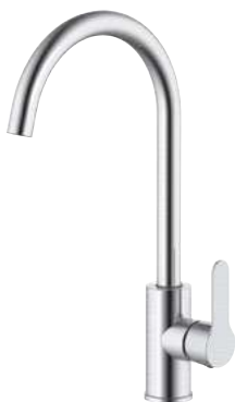
GRIFO FREGADERO MONOMANDO INOX MINO CAÑO ALTO 23002662 Cartucho Ø35/POM y cerámica. Aireador H22, latiguillos: H-M 3/8" 1/10" 40 cm. 34'67 + IVA = 41'95
